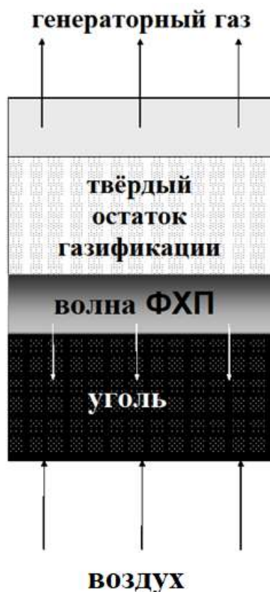
Рисунок 16 – Схема процесса «ТЕРМОКОКС-С»
