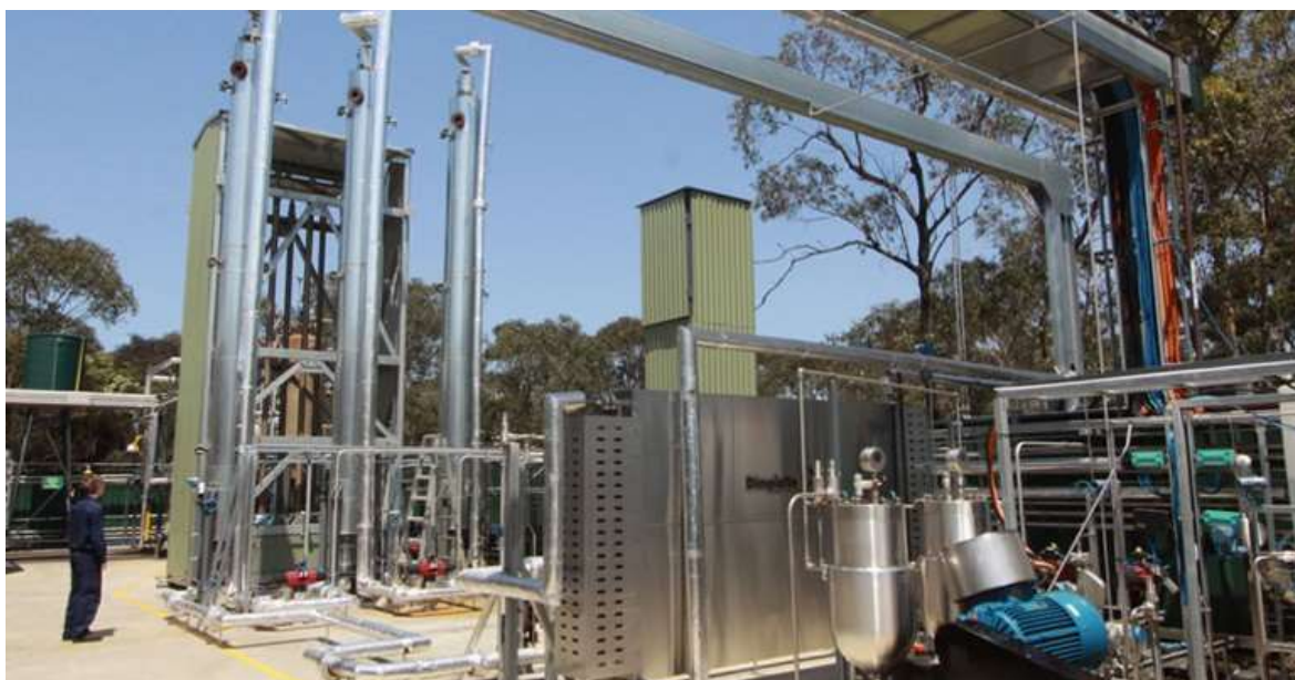
Рисунок 13 – Демонстрационная установка Ignite «Cat-HTR»
