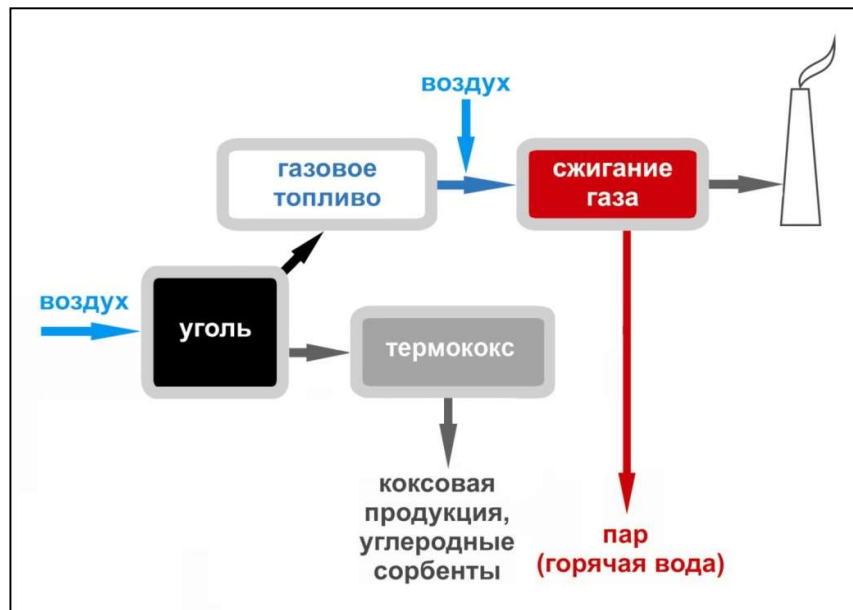
Рисунок 14 – Принципиальная схема энерготехнологической концепции ТЕРМОКОКС
