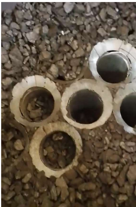
Рисунок 69 – Трубная решетка с воронками в процессе эксперимента
