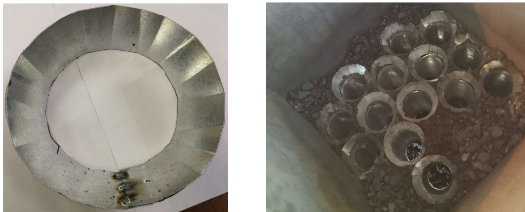
Рисунок 68 – Воронки (слева – фотография воронки, справа – фотография трубной решетки с воронками)
