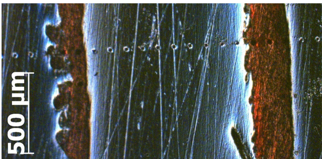
Рис. 2. а) зависимость значений микротвердости от расстояния на слоистом образце Cu–Mo; б) изображение зон соединения трёх слоев молибдена и двух слоев меди
