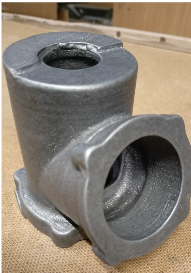
Рисунок 5.6 – Отливка «Корпус» из сплава АК9ч
