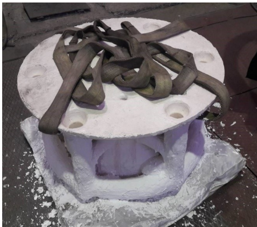
Рисунок 5.12 – Огнеупорная керамическая форма для отливки «Корпус камеры сгорания»
