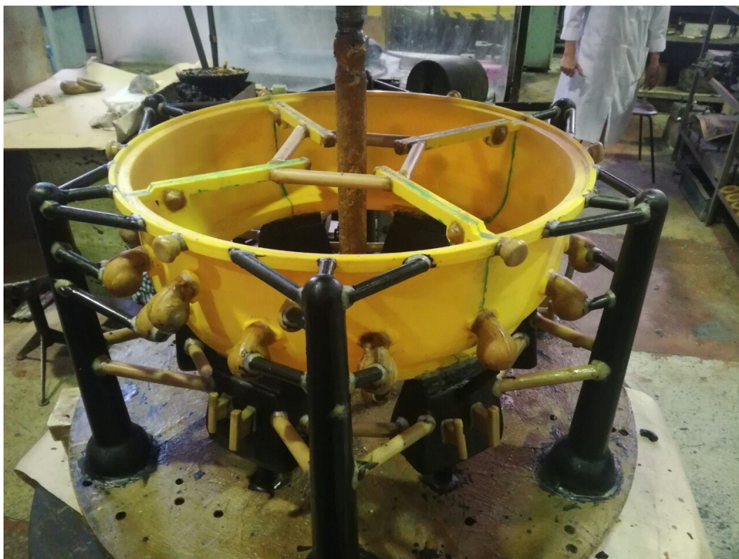
Рисунок 5.11 – Комбинированный модельный блок отливки «Корпус камеры сгорания»
