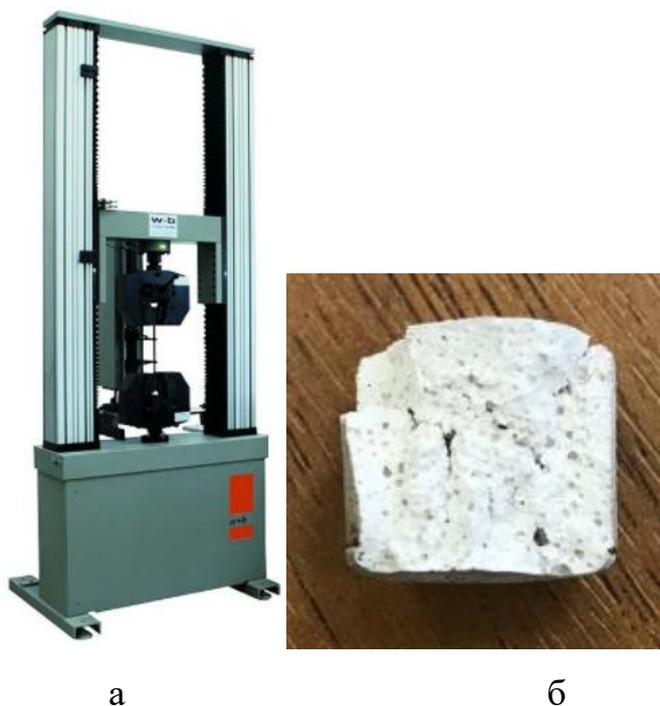
Рисунок 2.2 – Испытательная машина марки Walter+Bai AG (а), образец после испытания на прочность (б)
