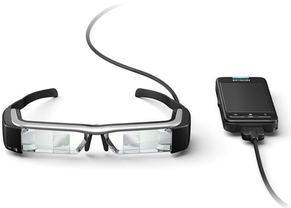
Рисунок 1 – Очки дополненной реальности Epson Moverio BT-200 с контроллером
