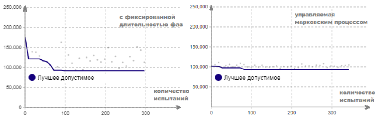
Рисунок 2.4 — Суммарное время, затраченное машинами на преодоление участка дорожной сети, справа на оси ординат показано значение для модели, управляемой марковским процессом, слева показано значение для модели перебора. На оси абсцисс указано количество экспериментов.
