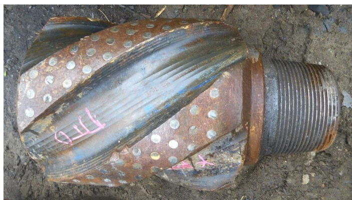
Рисунок 17 – Фрагмент калибратора после разрушения, \times 0,13
