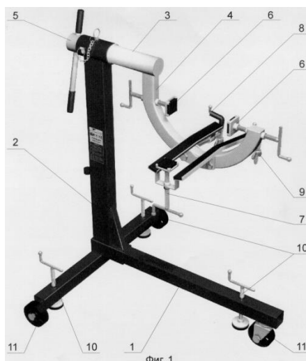
Рисунок 3.2 – Патент № 2270745 стенда для сборки и разборки изделий
