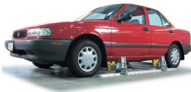
Рисунок 3.5 – Напольная анкерная система EZE TIE Down
