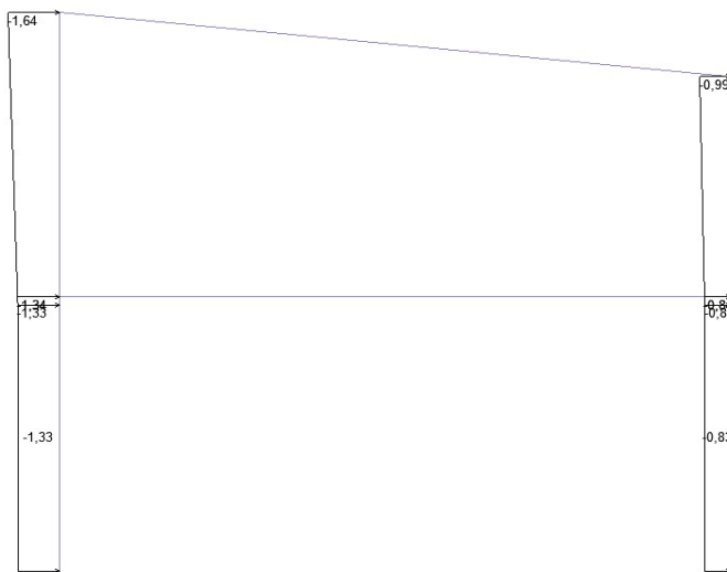
Рисунок 2.1.6 – Схема приложения ветровой нагрузки на раму
