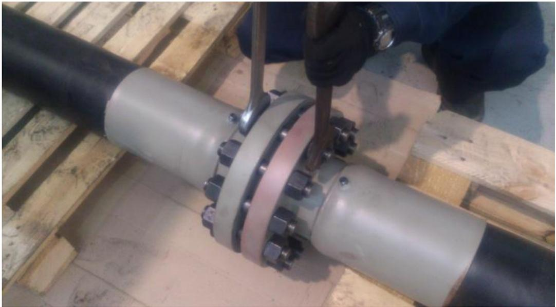
Рисунок 13 – Общий вид соединения двух фитингов с фланцами
