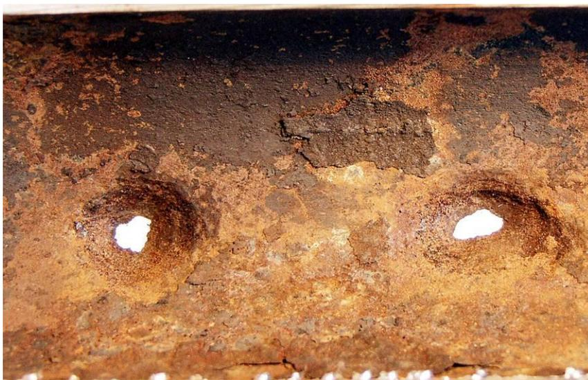
Рисунок 8 – Ручейковая коррозия
