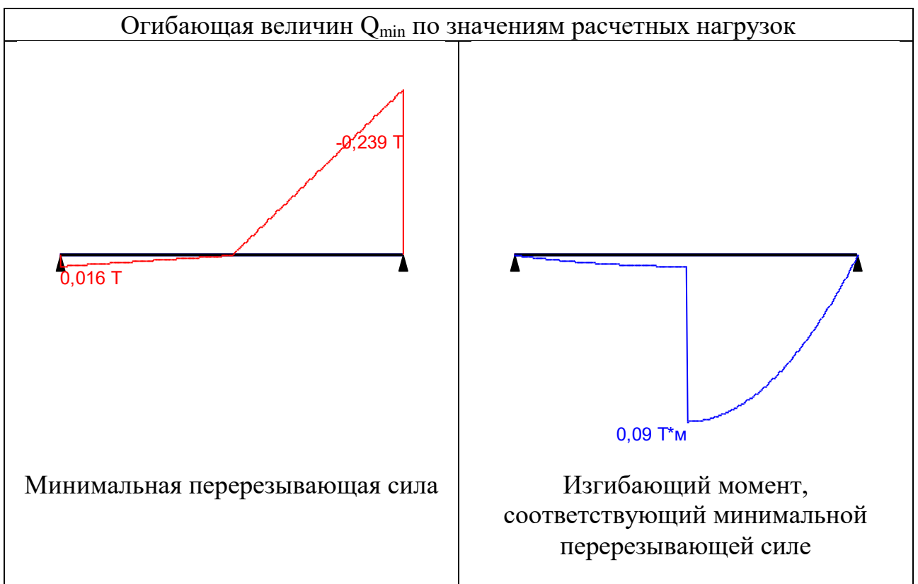
Рисунок 2.25 – Схема приложения нагрузок загрузки 1 (собственный вес) на прогон. Эпюры изгибающих моменты и перерезывающей силы
