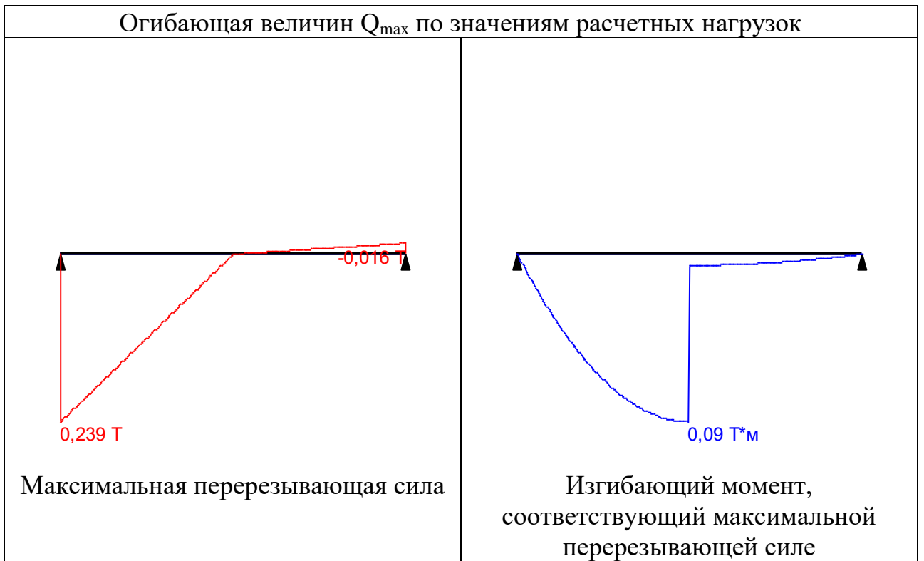
Рисунок 2.24 – Схема приложения нагрузок загрузки 1 (собственный вес) на прогон. Эпюры изгибающих моменты и перерезывающей силы
