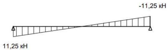
Рисунок 2.9 - Перерезывающая сила, соответствующая минимальному изгибающему моменту
