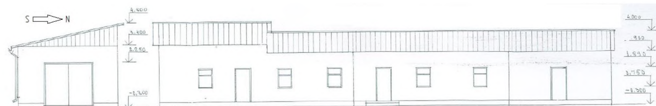
Рисунок 3 – Уровни крыши хозблока над уровнем пола
