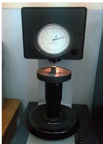
Рисунок 28 – Измерение твёрдости образца на приборе ТК-2М.
