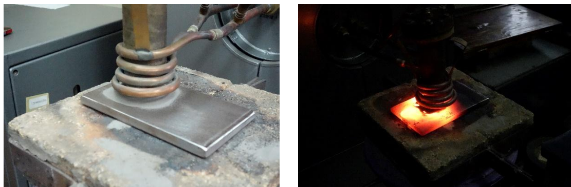
Рисунок 36 – Наплавление порошка ПГ-С27 «Сормайт»
