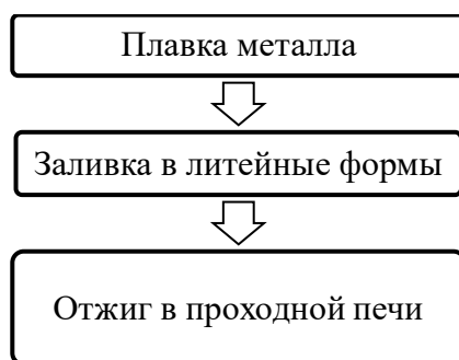
Рисунок 3 - Схема технологического процесса производства продукции в литейном цехе ООО «ЛПЗ» Сегал»
