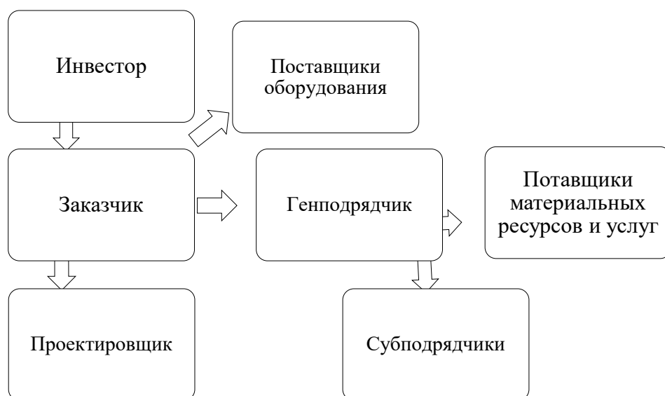
Рисунок 8 – Взаимоотношения между участниками строительного процесса
