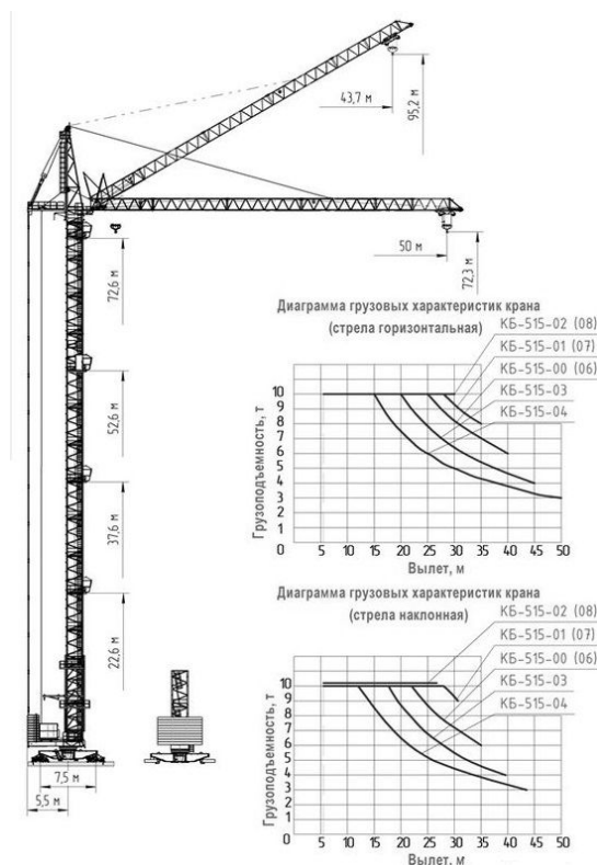
Рисунок 1 – Грузовые характеристики крана КБ – 515
