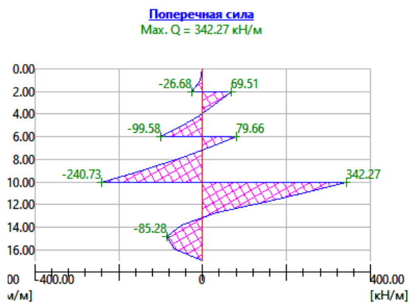
Рисунок 3.23 – Результаты расчета шпунтового ограждения (поперечная сила [кН/м])
