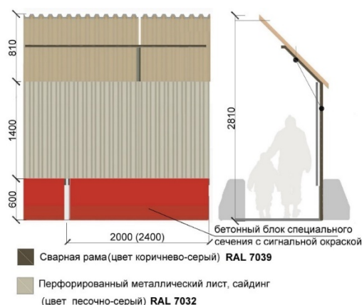
Рисунок 5.1 – Временное ограждение строительной площадки (тип 3А Н)
