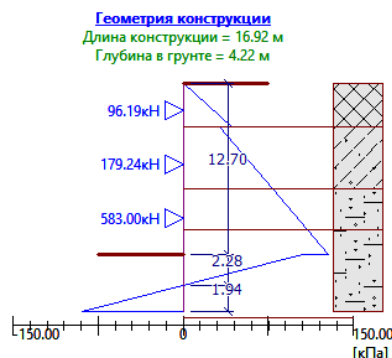
Рисунок 3.21 – Результаты расчета шпунтового ограждения (геометрия конструкции)
