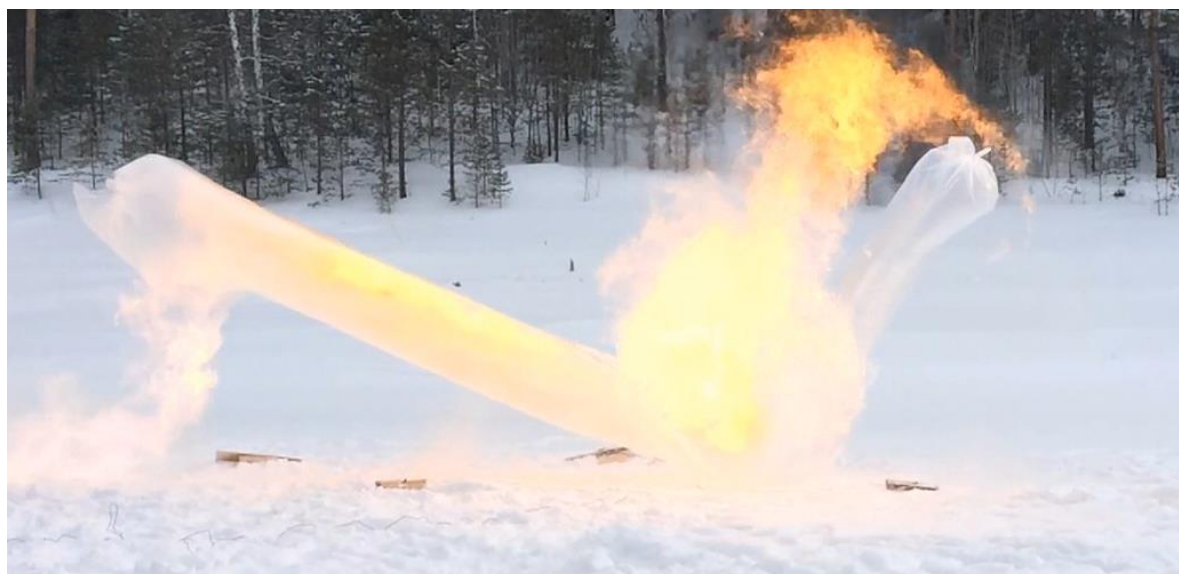
Рисунок 3.22 – Выход ГВС за пределы рукавной линии
