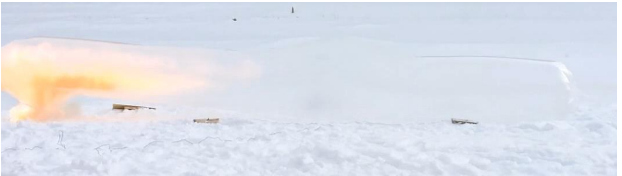
Рисунок 3.20 – Разрыв рукавной линии
