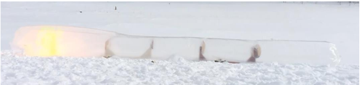
Рисунок 3.25 – Появление избыточного давления и разрыв рукавной линии
