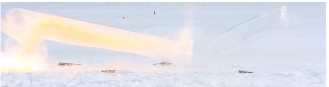
Рисунок 3.21 – Схлопывание рукавной линии
