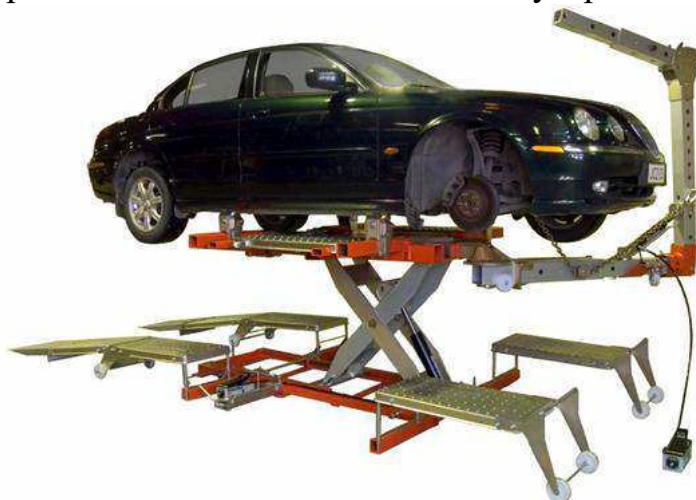
Рисунок 3.7 – Пример стенов для восстановления геометрических размеров кузова или рамы - стапель Autorobot XLS++
