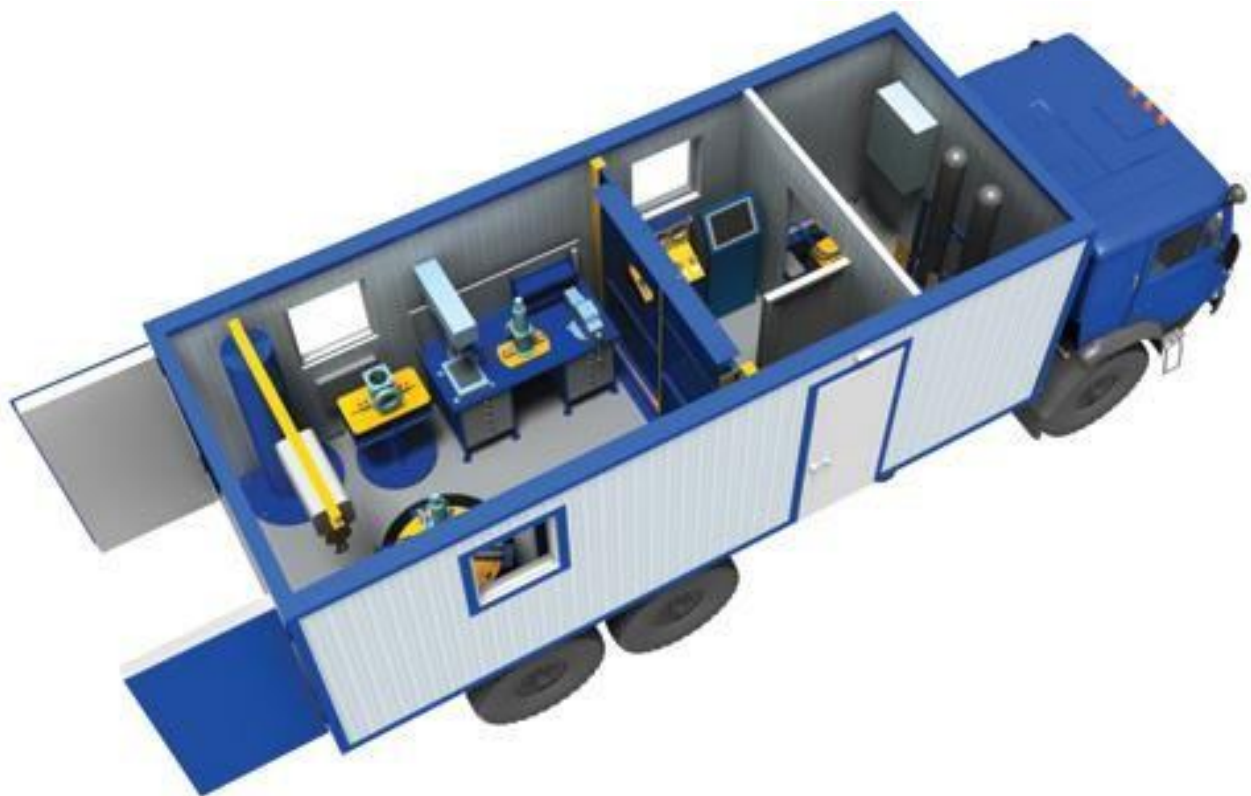
Рисунок 2.6 - Передвижная ремонтная мастерская
