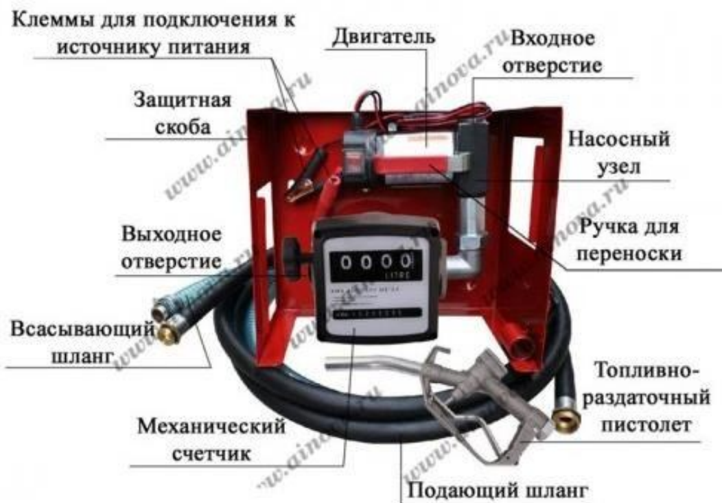
Рисунок 3.8 – Топливоперекачивающий насос со счетчиком
