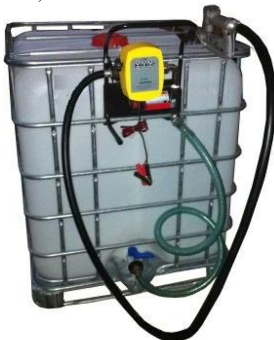
Рисунок 3.7 – Еврокуб с насосом для перекачки топлива
