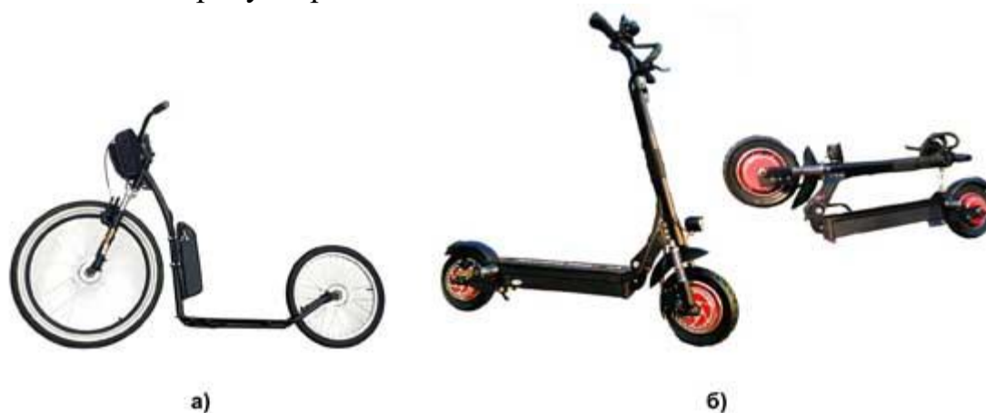
Рисунок 1.14 - Полноприводные электросамокаты: а) VoltDualpro 2620 с двигателями мощностью 350 Вт; б) RedDragonDualdrive с 1-киловаттными двигателями
