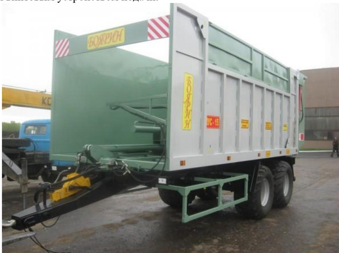
Рисунок 2.4 – Прицепы с активизацией разгрузки сталкивающего типа с гидравлическим приводом
