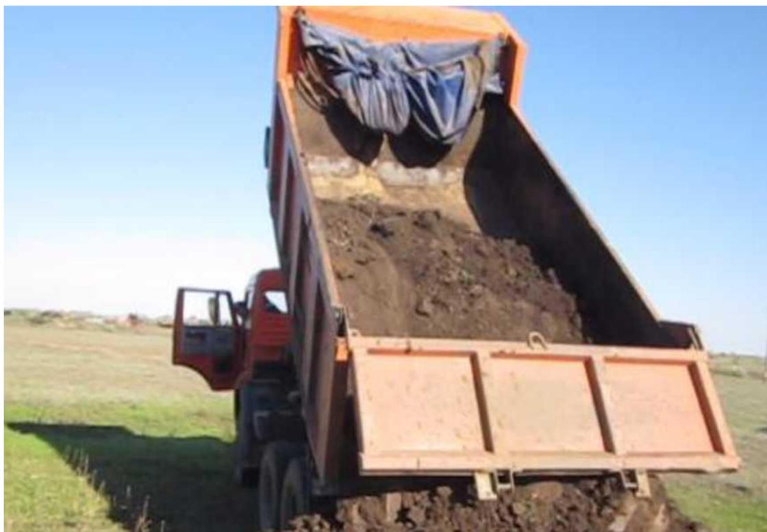
Рисунок 2.1 - Неполная разгрузка кузова транспортного средства
