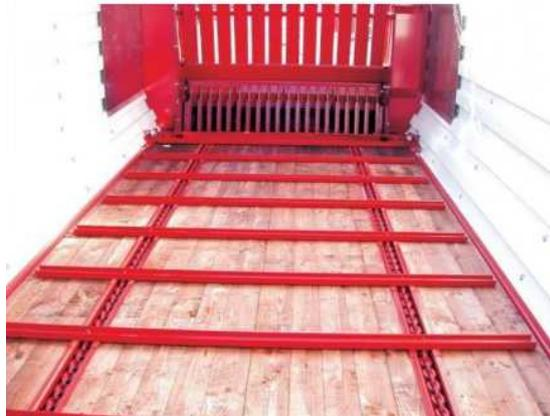
Рисунок 2.5– Прицепы с активизацией разгрузки сталкивающего типа с цепным приводом
