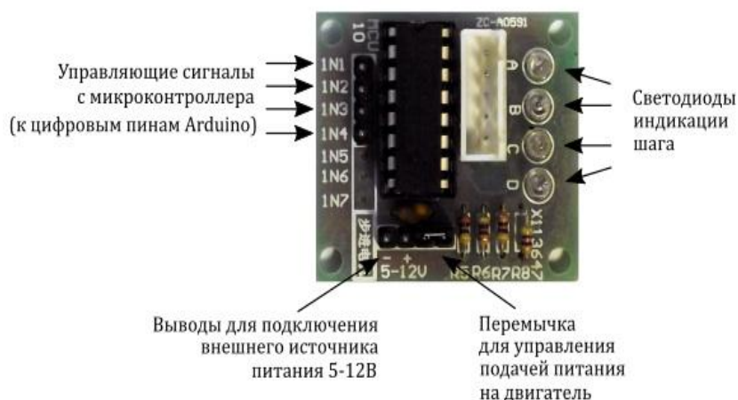
Рисунок 2.12-Плата управления на базе ULN2003
