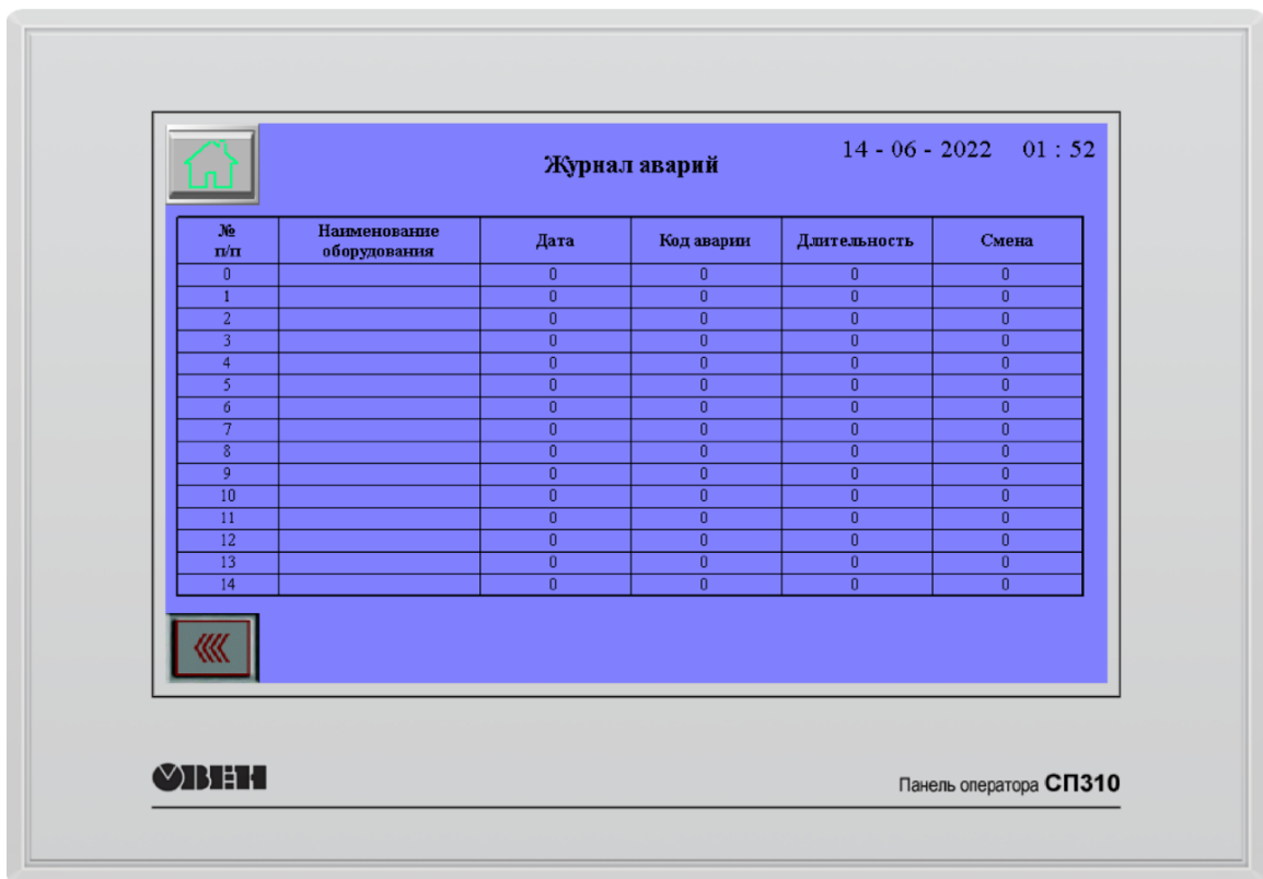
Рисунок 19 - Экраны панели оператора ОВЕН СП310: журнал аварий оборудования
