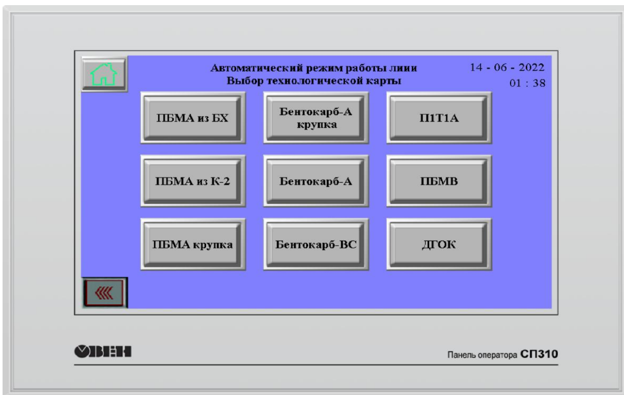
Рисунок 11 - Экраны панели оператора ОВЕН СП310: выбор варианта работы в ручном режиме с возможностью создания технологической карты
