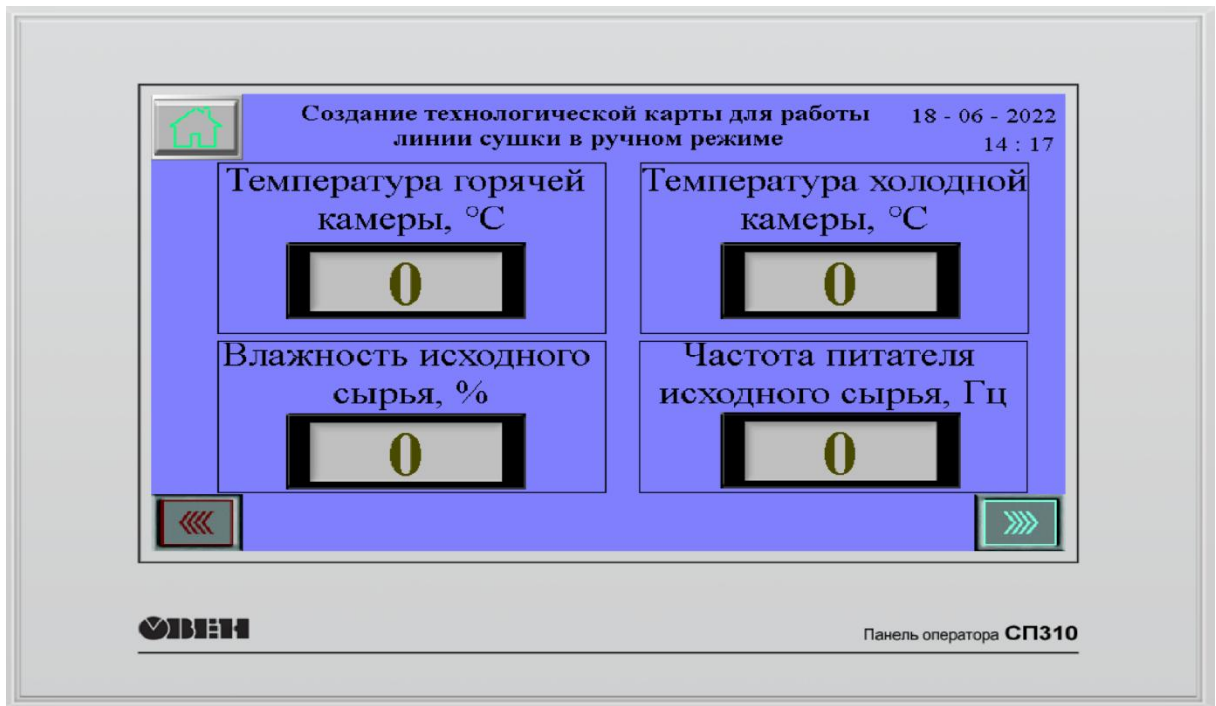
Рисунок 13 - Экраны панели оператора ОВЕН СП310: меню создания технологической карты с окнами ввода данных
