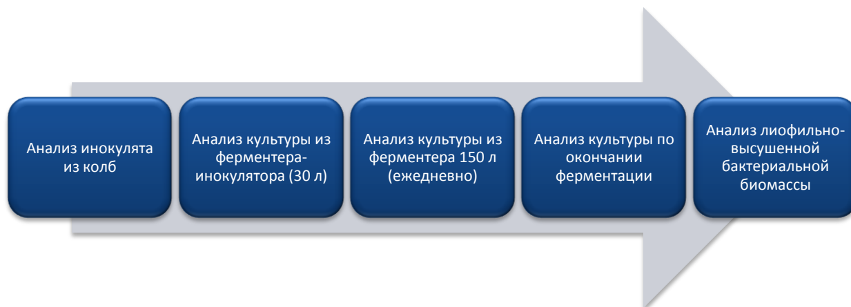
Рисунок 3– Схема проведения микробиологического анализа чистоты бактериальной культуры
