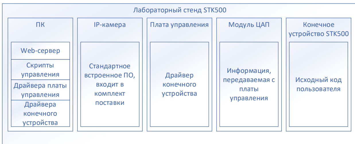
Рисунок 7 – Схема архитектуры стенда
