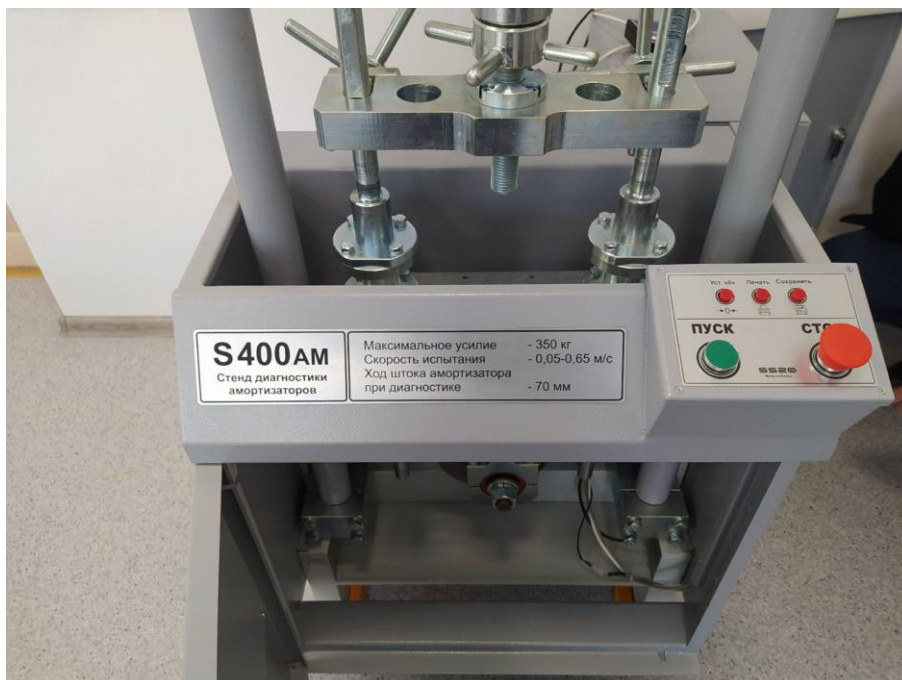
Рисунок 4 - Стенд диагностики амортизаторов SS20 S400 AM
