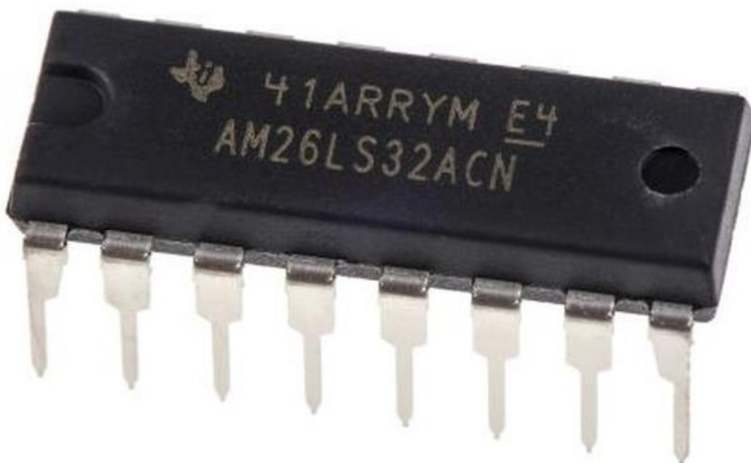
Рисунок 12 - Счетверенный дифференциальный линейный приемник AM26LS32ACN
