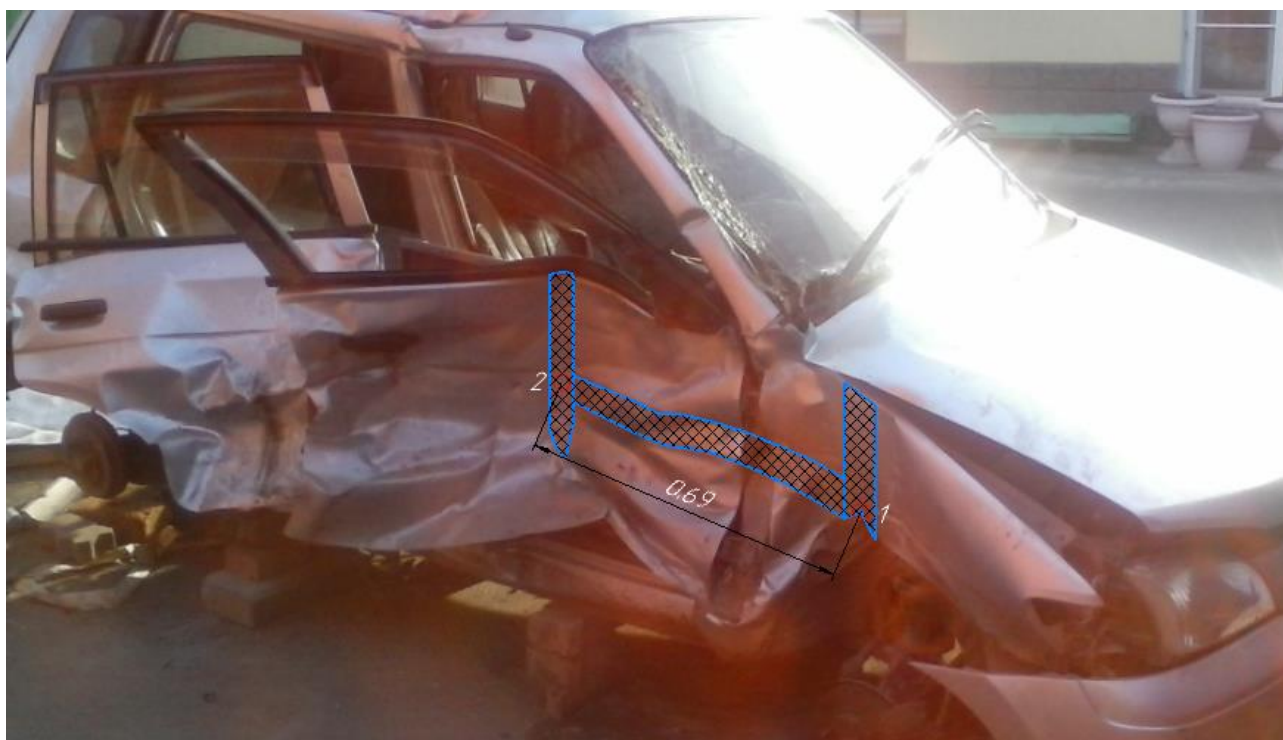
Рисунок 1 – Сопоставление основных точек взаимодействия во время ДТП на основании повреждений ТС MAZDA DEMIO
