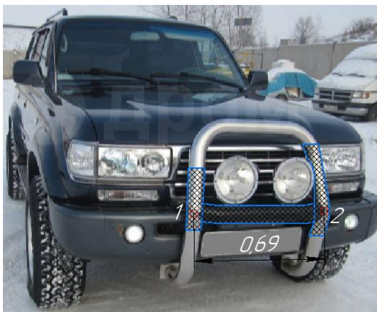
Рисунок 2 – Сопоставление основных точек взаимодействия во время ДТП на основании фотографии ТС TOYOTA LAND CRUISER до ДТП
