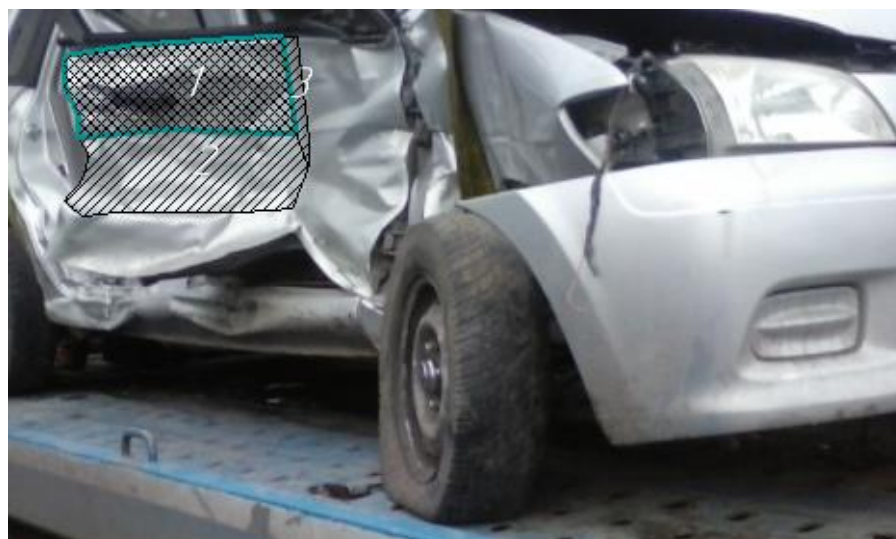
Рисунок 4 – Конструктивные элементы передней части ТС TOYOTA LAND CRUISER, взаимодействующие с поврежденными поверхностями ТС MAZDA DEMIO
