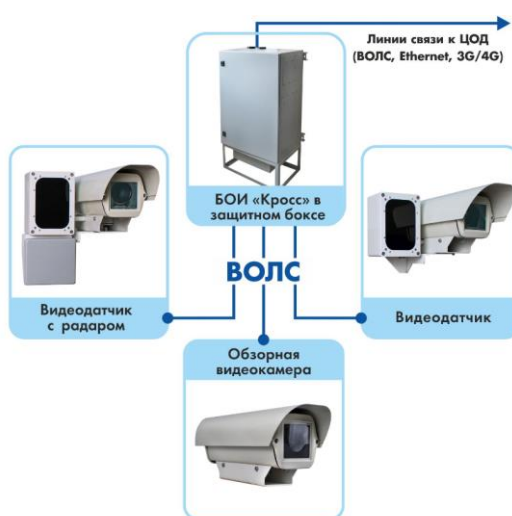
Рисунок 2.33 – Схема работы комплекса «КОРДОН-КРОСС»
