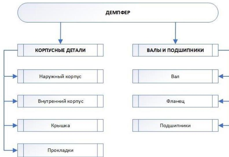
Рисунок 4.2 – Укрупненная модель демпфера большегрузного самосвала
