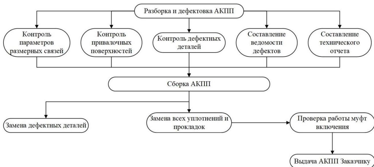
Рисунок 3.3 – Структурная схема последовательности проведения работ по разборке и дефектовке АКПП большегрузного самосвала Komatsu HD785-7
