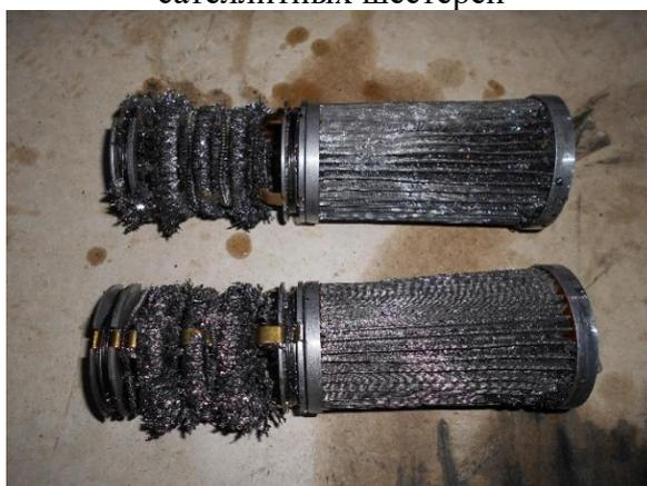
Рисунок ПВ.6. Последствия износа, разрушения деталей АКПП
