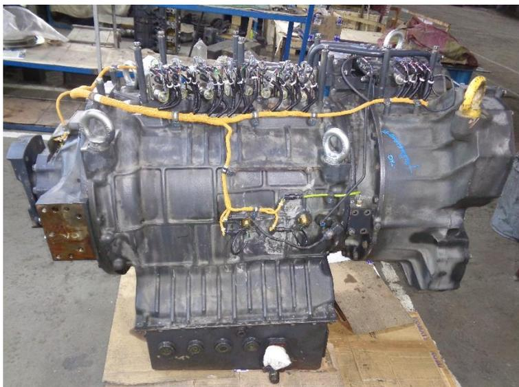
Рисунок 3.2 – Автоматическая коробка переключения передач большегрузного самосвала Komatsu HD785-7 в сборе
