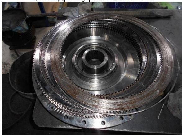
Рисунок ПВ.3. Износ дисков и пластин муфты включения
