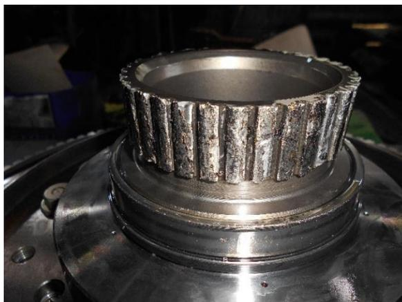
Рисунок ПВ.2. Механическое разрушение шлицев промежуточной муфты
