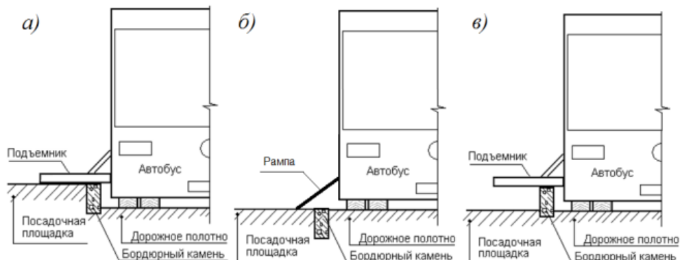
Рисунок 3.5 – Классификация остановочных пунктов: а – доступны для работы подъемника и рампы; а, б – доступны для работы подъемника; б, в – не доступны для обслуживания автобусов с рампой и подъемником.
