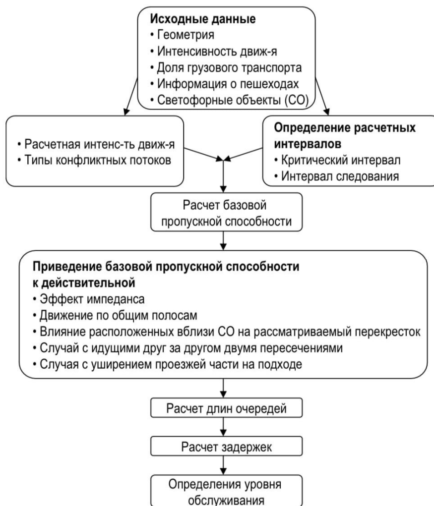
Рисунок 1.13 – Последовательность расчета пропускной способности на нерегулируемых и кольцевых пересечениях
