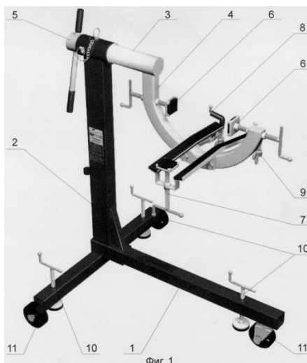
Рисунок 3.2 – Патент № 2270745 стенда для сборки и разборки изделий
