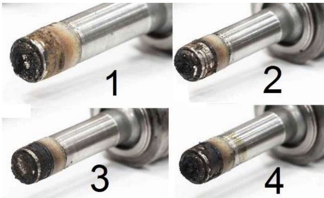
Рисунок 2.3 – Нагар на форсунках системы Skyactive
