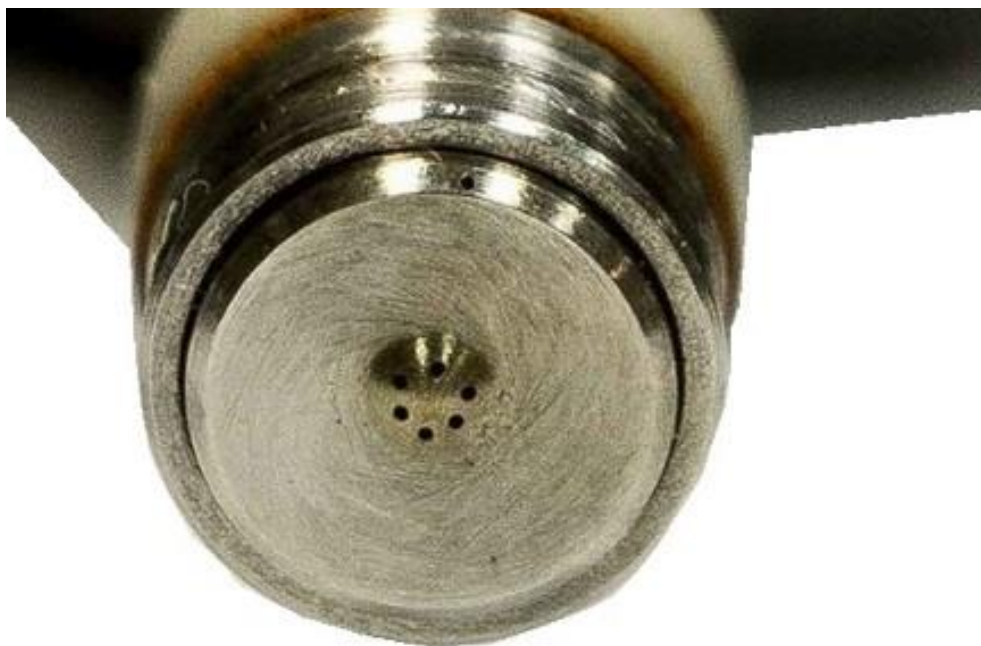
Рисунок 2.4 – Форсунка после очистки на ультразвуковом стенде АЕ&Т НР-6В.
