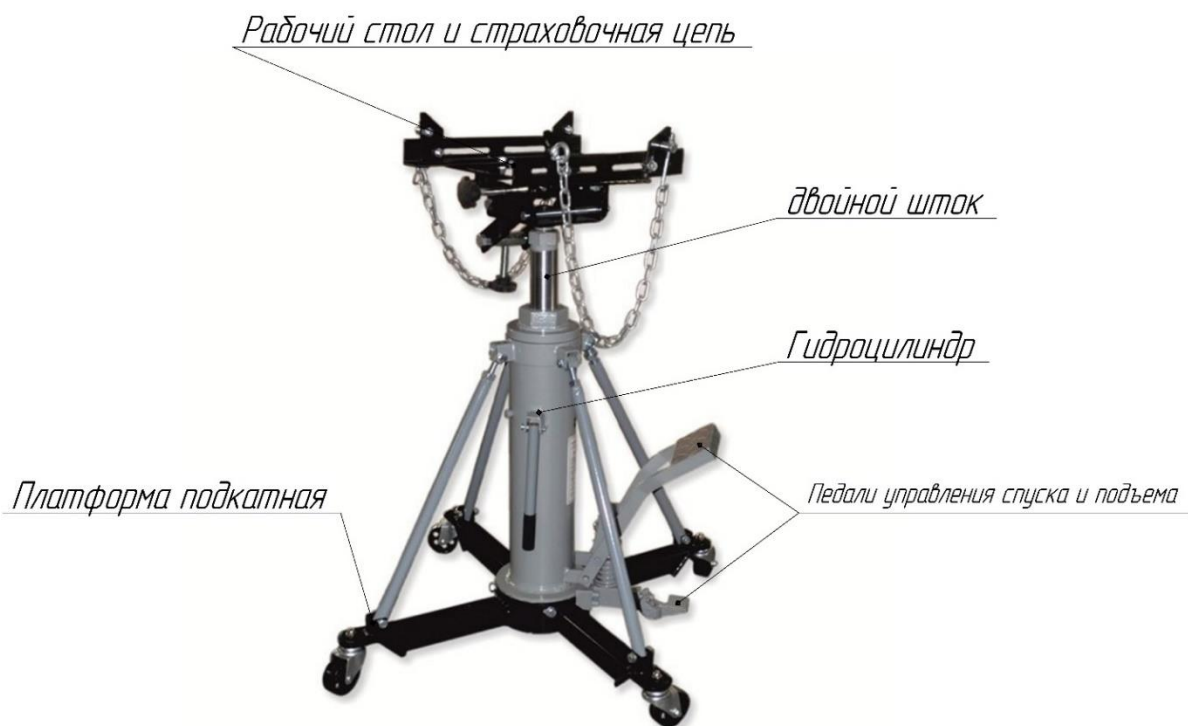
Рисунок 3.2 – внешний вид и конструктивные элементы стойки Wiederkraft WDK-80591
