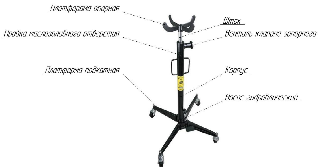
Рисунок 3.1 – внешний вид и конструктивные элементы стойки Berger BG 1276
