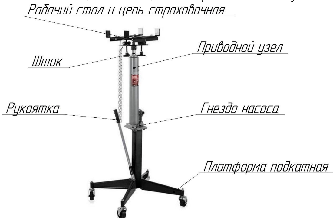
Рисунок 3.3 – внешний вид и конструктивные элементы стойки MATRIX 567385
