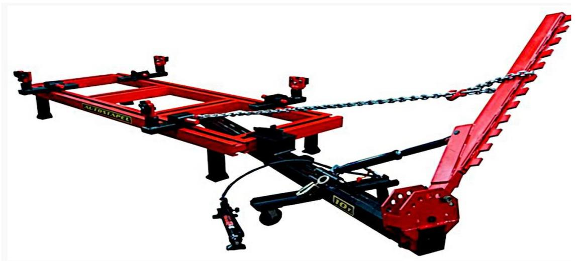
Рисунок 3.4 – Стапель для кузовного ремонта AUTOSTAPEL Express рамный
