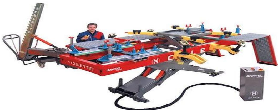
Рисунок 3.3 – Стапель для кузовного ремонта Griffone 2800 Evolution
