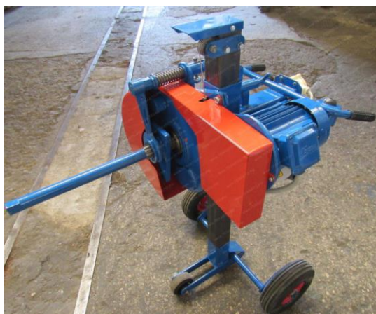
Рисунок 5.2 – Вид гаражного гайковёрта И-330 для откручивания и закручивания гаек колёс грузовых автомобилей и автобусов
