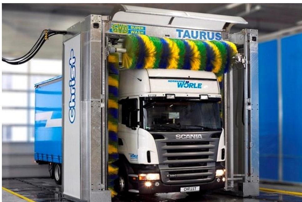
Рисунок 3.6 – Общий вид портальной автоматической мойки
