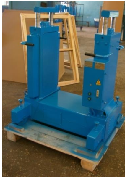
Рисунок 3.5 – Подъёмник стационарный электромеханический ПС-10
