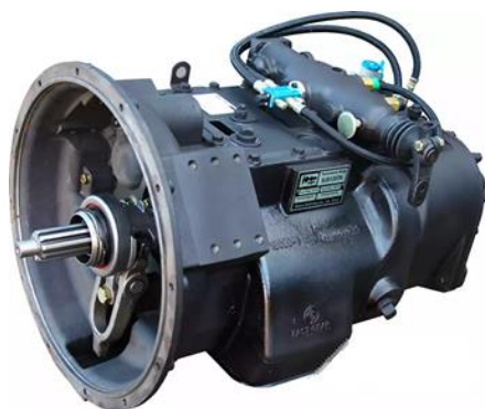
Рисунок 2.3 – Общий вид КПП 9JS135TA Fast Gear
