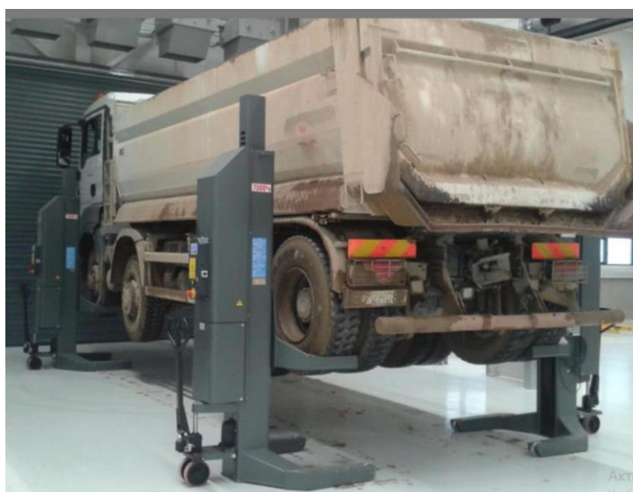
Рисунок 3.3 – Подъемник передвижной Sivik ПГП-36000
