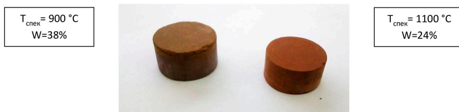
Рис. 7. Образцы керамических материалов на основе дисперсной фракции золы КА-3
