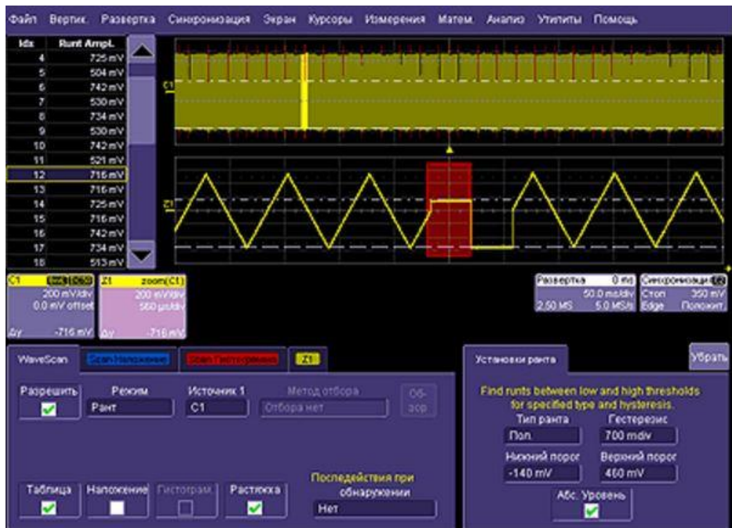
Рисунок 8 – настройка поиска аномалий и ранты, обнаруженные при помощи метода Wave Scan
