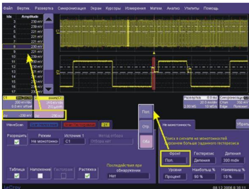
Рисунок 7 – настройка поиска аномалий и немонотонности, обнаруженные при помощи метода Wave Scan
