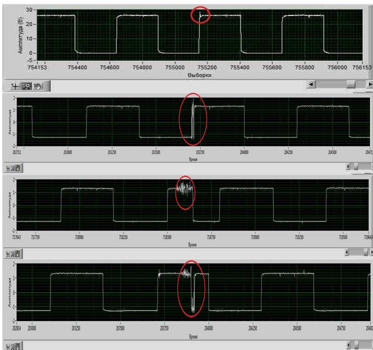
Рисунок 42 – примеры аномалий, обнаруженных в результате анализа осциллограмм, полученных от ДБЭ63-25-6,3
