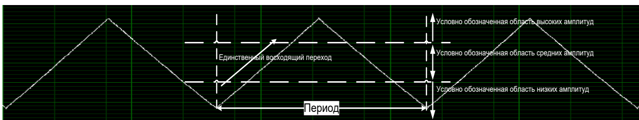
Рисунок 22 – периодический электрический сигнал треугольной формы
