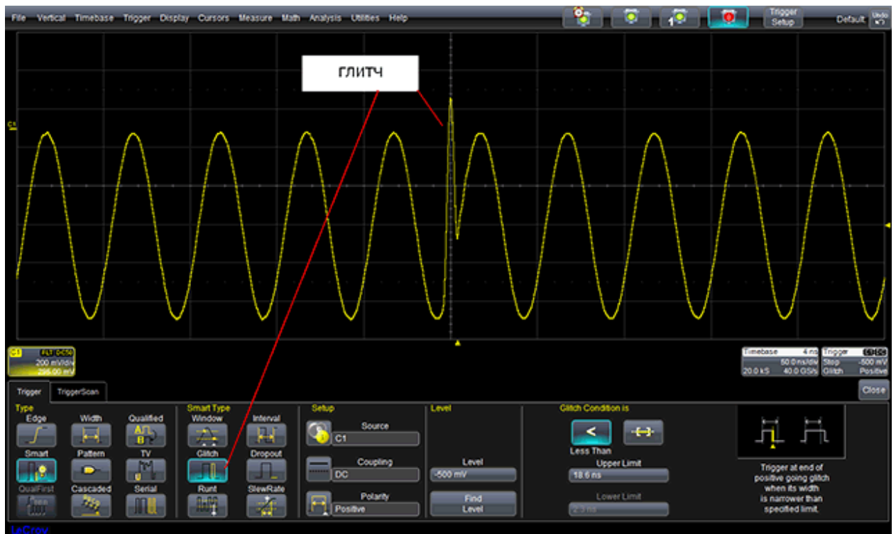
Рисунок 11 – настройка поиска аномалий и глитч, обнаруженный при помощи метода Trigger Scan
