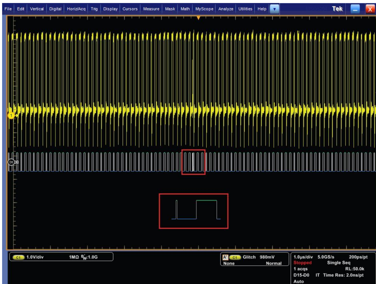
Рисунок 5 – настройка поиска аномалий и импульсы с нарушением длительности, обнаруженные при помощи метода Wave Inspector
