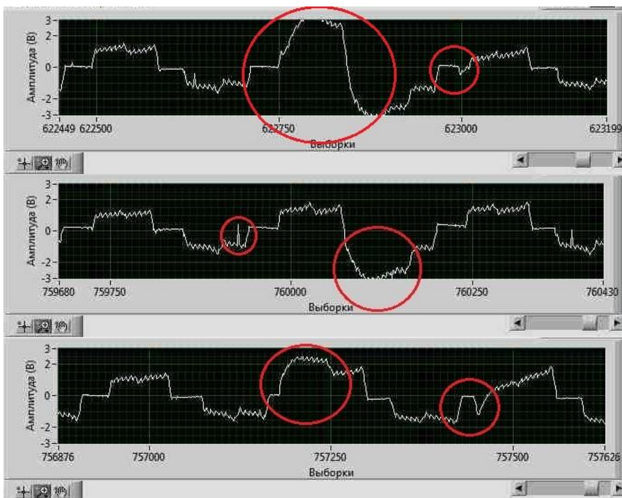
Рисунок 43 – примеры аномалий, обнаруженных в результате анализа осциллограмм, полученных от ДБЭ63-25-6,3
