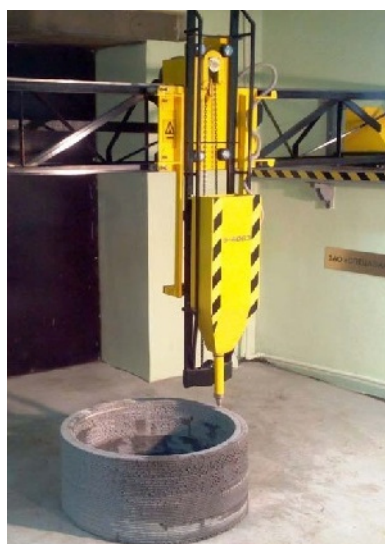
Рисунок 1.9–Строительный 3D-принтер S-4063
