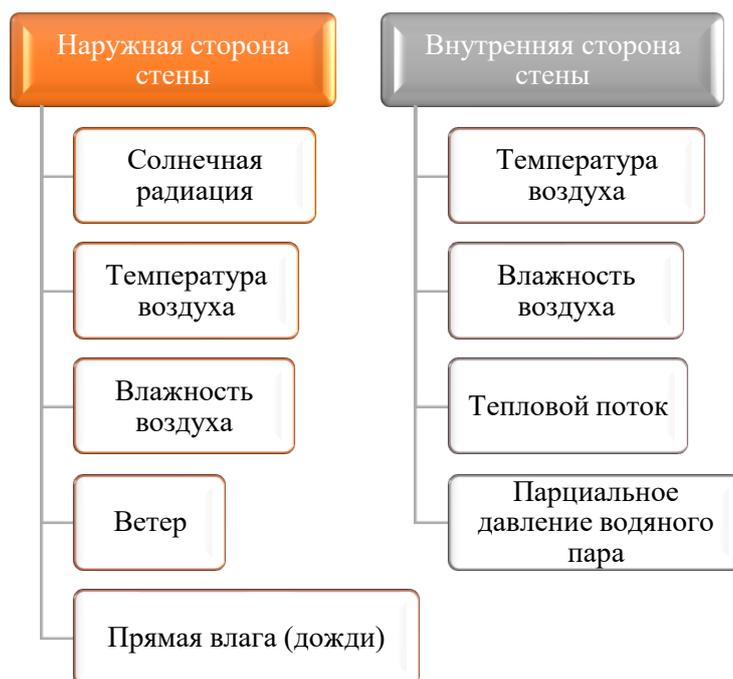
Рисунок 2.1 - Основные физико-климатические воздействия на стены зданий
