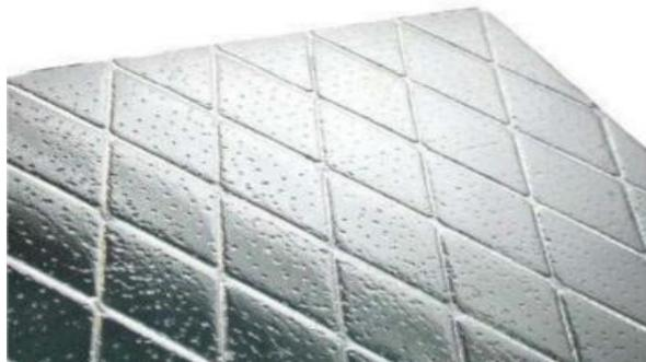
Рисунок 1.18 – Панель с вакуумной изоляцией
