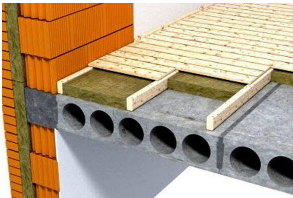
Рисунок 4.6 - Утепление плитных перекрытий подвала
