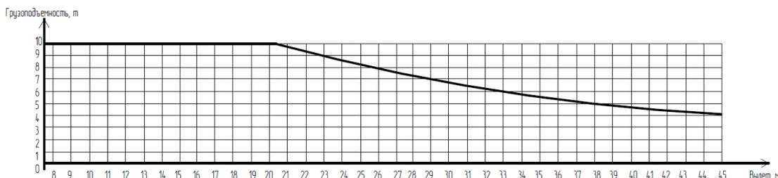
Рисунок 4.1 – График грузоподъемности башенного крана КБ-503А.2
