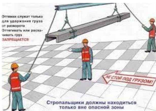
Рисунок 5.3 – Правила выполнения монтажа стальных конструкций
