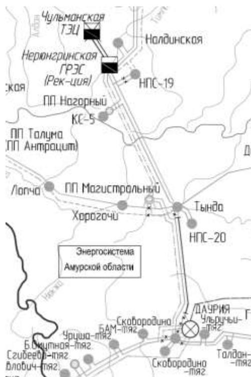
Рисунок 10 – Карта-схема размещения линий электропередач и подстанций напряжением 220 кВ и выше и электростанций в районе сечения № 4 на 2022 – 2028 годы
