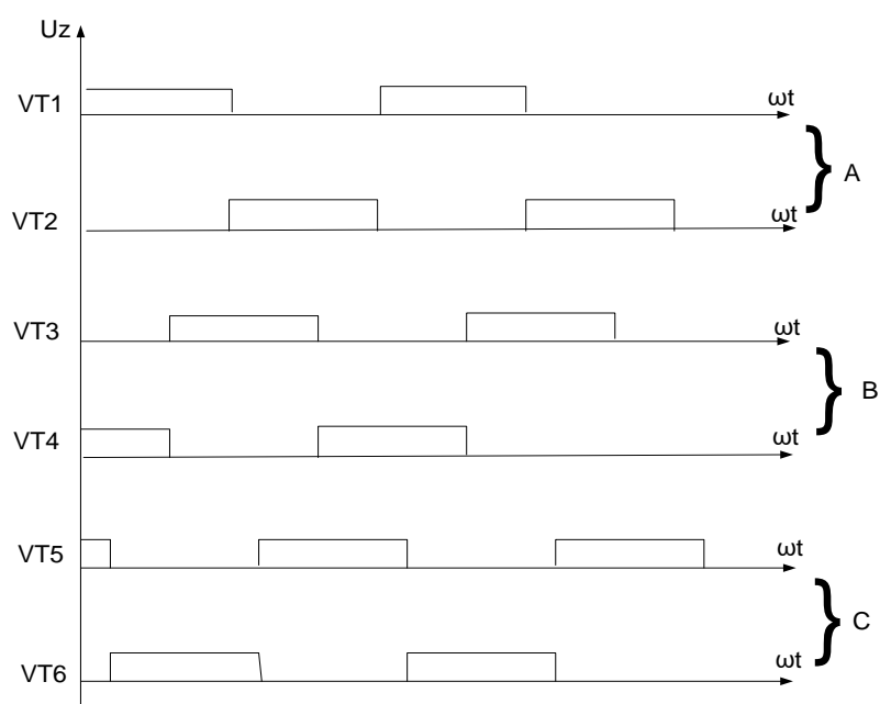
Рисунок 2.6 – Алгоритм подачи импульсов на транзисторы
