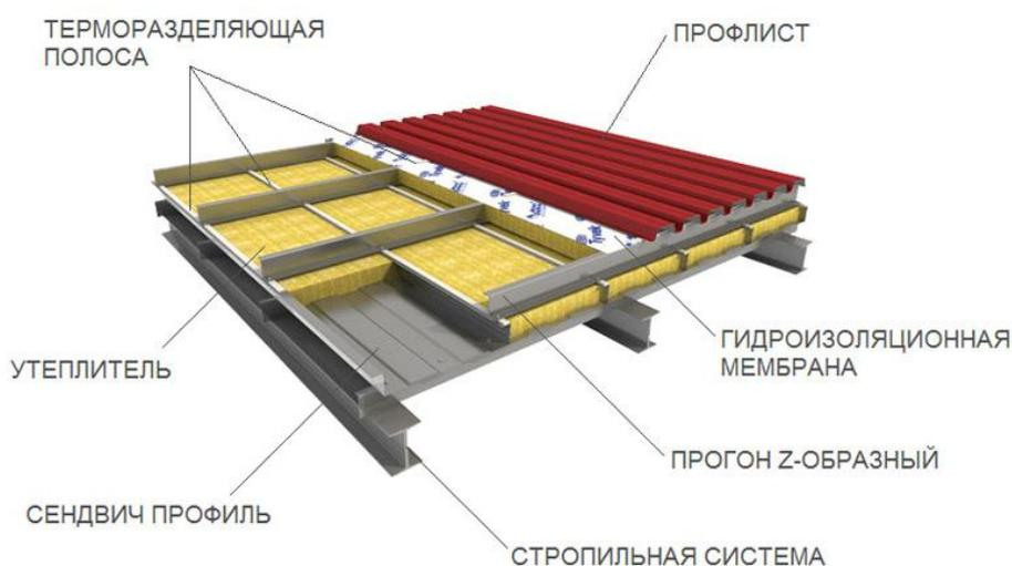
Рисунок 2.2 – Конструкция кровельной панели поэлементной сборки
