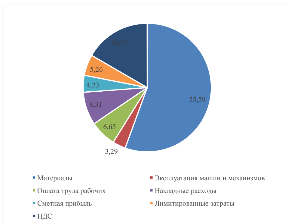
Рисунок 6.1 – Структура локального сметного расчета в процентах на устройство монолитных железобетонных колонн по составным элементам
